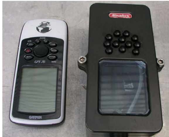
Das Garmin GPS76 und das passende Sealux-Gehäuse - auch geeignet für Garmin GPS 72 und GPSmap 76cx
