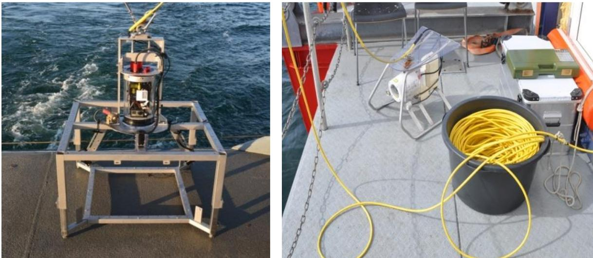
**Abb. 1:** Die neu entwickelte Dropkamera des BfN (links) und der BfN-Videoschlitten mit UW-Kabel (rechts).
